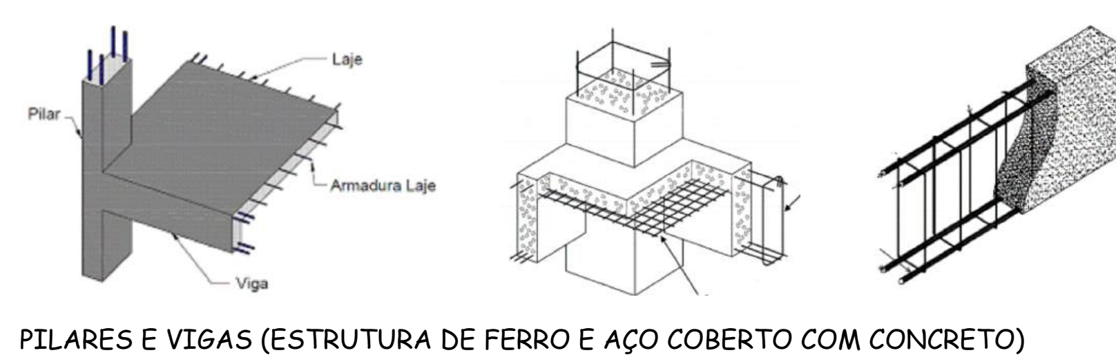
PILARES E VIGAS (ESTRUTURA DE FERRO E AÇO COBERTO COM CONCRETO)
